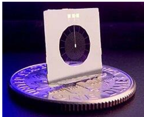
Fig. 7.5: Bolomètre de type « spiderweb » pour mesurer le fond diffus cosmologique par NASA/JPL-Caltech [27].
