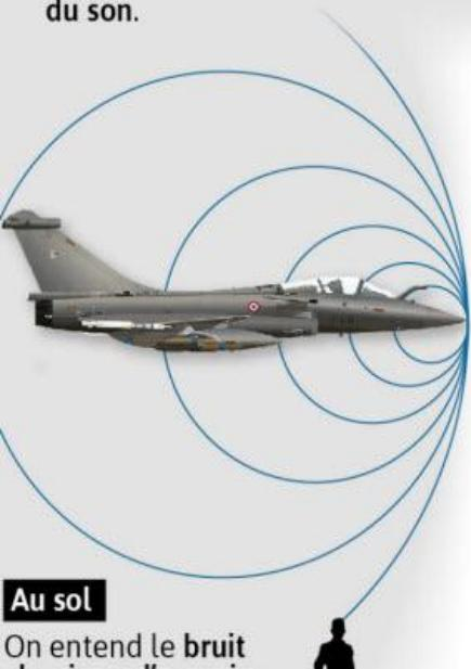
2 Lorsque l'avion franchit le mur du son, c'est-à-dire qu'il dépasse Mach 1 (1 224 km/h\*), les ondes concentrées devant le nez de l'appareil sont libérées et forment un cône de choc.
