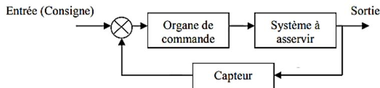
Fig . 06. Schéma d'un système de commande en boucle fermée
