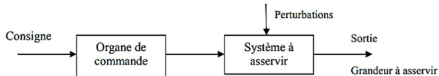
Fig . 05. Schéma d'un système de commande en boucle ouverte
