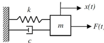
Figure 1. Modélisations d'un système masse-ressort-amortisseur.
