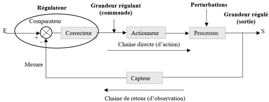
Fig 01. Schéma bloc d'un système asservi
