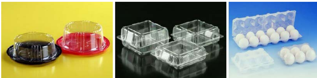
Figure. 2.8 : Objets mise en œuvre avec le procédé thermoformage
