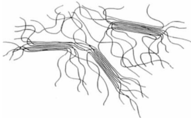
Figure 3.1 Représentation schématique d'un polymère semi-cristallisé
