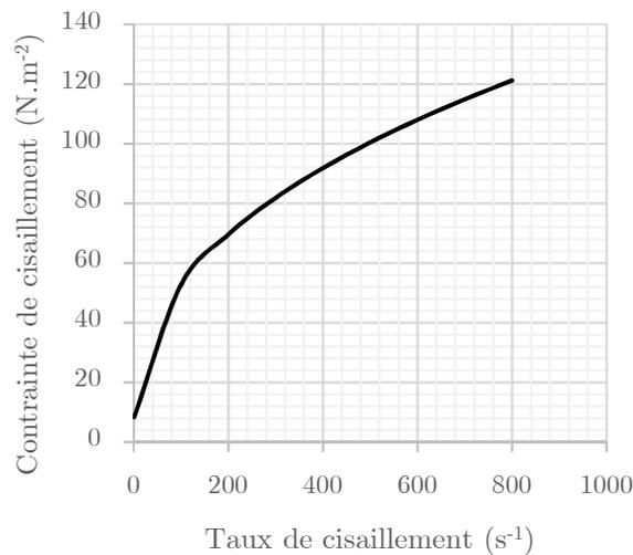
**Figure 2.** Contrainte de cisaillement en fonction du taux de cisaillement.
