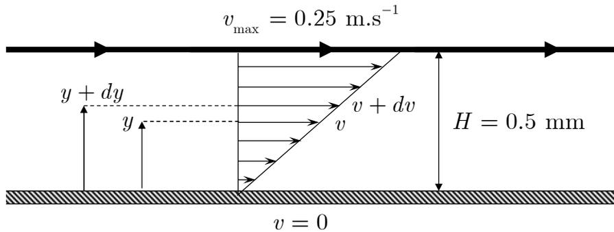
Figure 1. Profil de vitesse entre deux plaques, fixe et mobile
