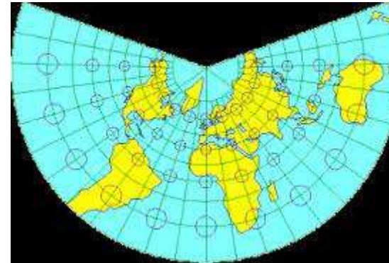
Figure 9, projection conique de la terre
