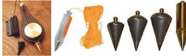
Est employé pour projeter au sol les points mesurés la pointe doit être tenue à quelques mm du sol. Il faut éviter qu'il balance.
