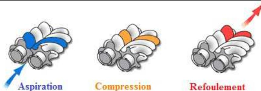
**Figure 14:** Cycle de compression d'un compresseur bi-vis
