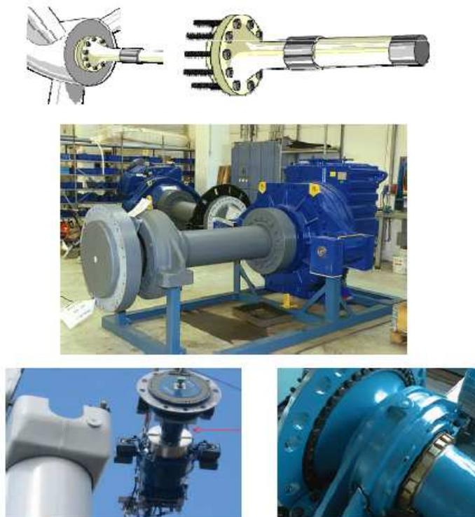
Figure 20. Arbre primaire d'une éolienne [2]
