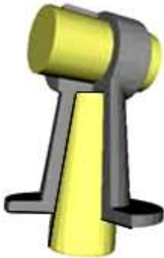
Tracé défectueux : noyau en porte à faux
