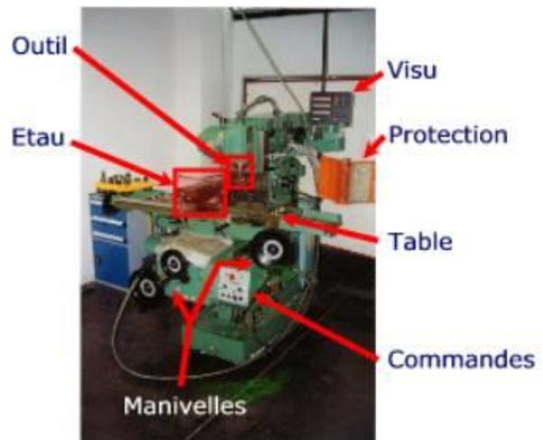
Sur ces deux machines le déplacement de l'outil sur la trajectoire d'usinage est réalisé par un opérateur. Pour cela, il utilise les manivelles permettant de générer les mouvements suivant les axes. Les mouvements ne sont possibles que sur un seul axe à la fois. Des moteurs permettent aussi de choisir des vitesses d'avance suivant les axes de déplacements. Le choix de ces vitesses s'effectue par l'intermédiaire d'une boîte de vitesse mécanique.
