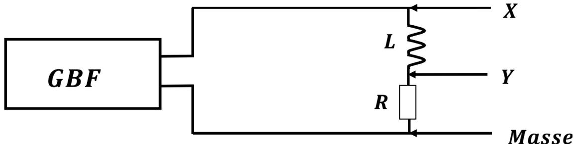
**Fig.6a Schéma à réaliser et à étudier pour les circuits RL et RC**
