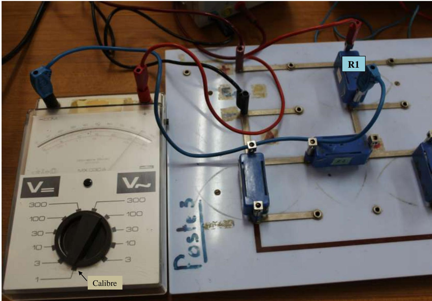
La 2<sup>ème</sup> méthode qui se base sur la loi d'Ohm  $U=RI$ , fait appel donc à l'usage d'un Voltmètre qui sera disposé **en parallèle** à la résistance  $R$  dont on veut mesurer la tension correspondante. L'exemple montre la mesure de la tension lue sur le calibre de 1V :  $U_1=0,88V$  (Zooomez). La même méthode s'applique pour le reste des autres  $R$ .
