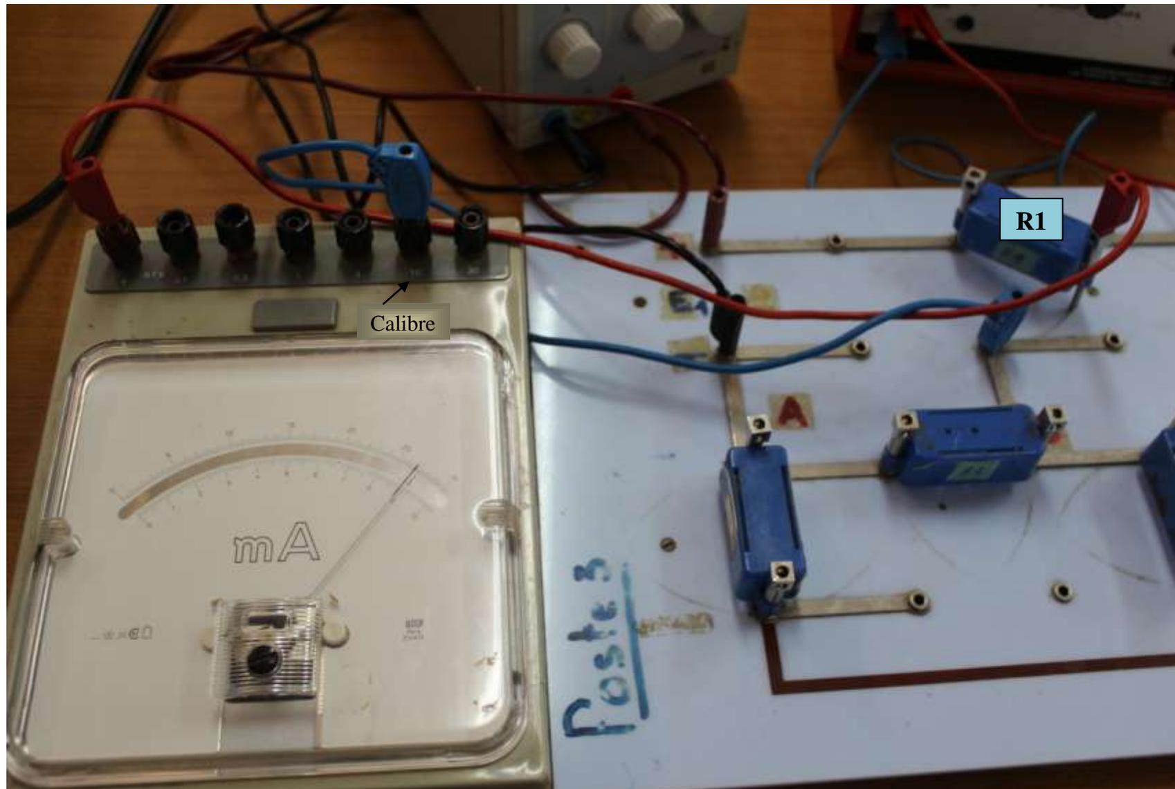
Puisqu'on ne peut pas placer l'ampèremètre en parallèle (risque de court-circuit) avec la résistance  $R_1$ , on est obligé d'enlever seulement une des deux bornes de  $R_1$  et le **brancher en série avec  $R_1$**  soit avant soit après (cas de la figure). La mesure affiche une valeur de  $I_1$  de : **8,9 mA** avec un **calibre de 10 mA** (Zoom)
