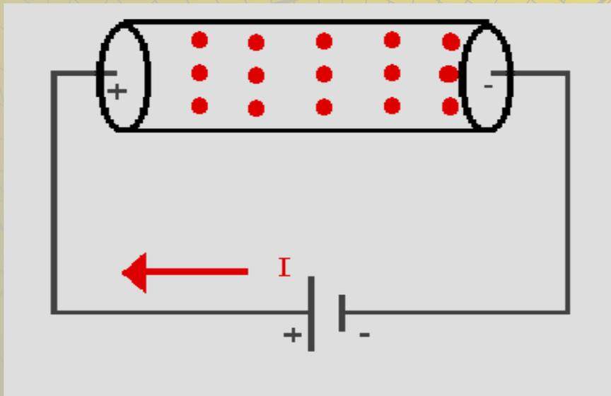
Par convention, le courant sort de la polarité positive, c'est le **sens inverse des électrons**.
